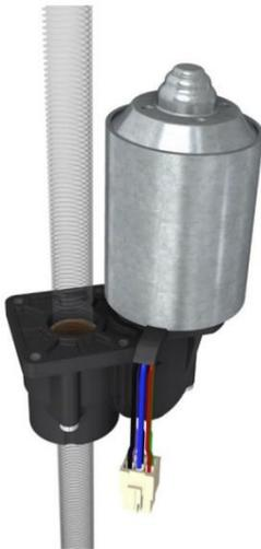
Kraftvoller 24 V DC Motor mit Schneckengetriebe, ausgelegt für eine achsparallele durchgehende Spindel. Optimal für die Integration in einer Hubsäule. Der Antrieb ist nur für axiale Druckbelastung geeignet. Ein Kabel mit Standardstecker und eine integrierte Hall-Sensorik erlauben eine einfache und sichere Ansteuerung des Gesamtsystems.
